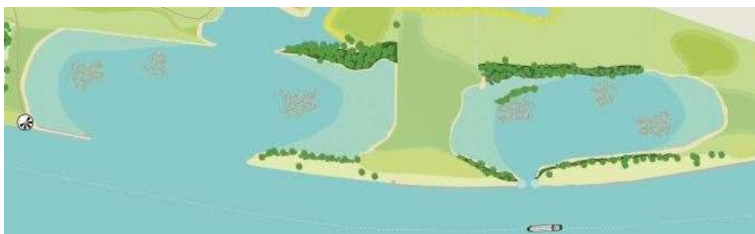
Figuur 2-1: verondieping plassen
